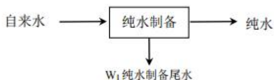
图 2-2 纯水制备工艺图
